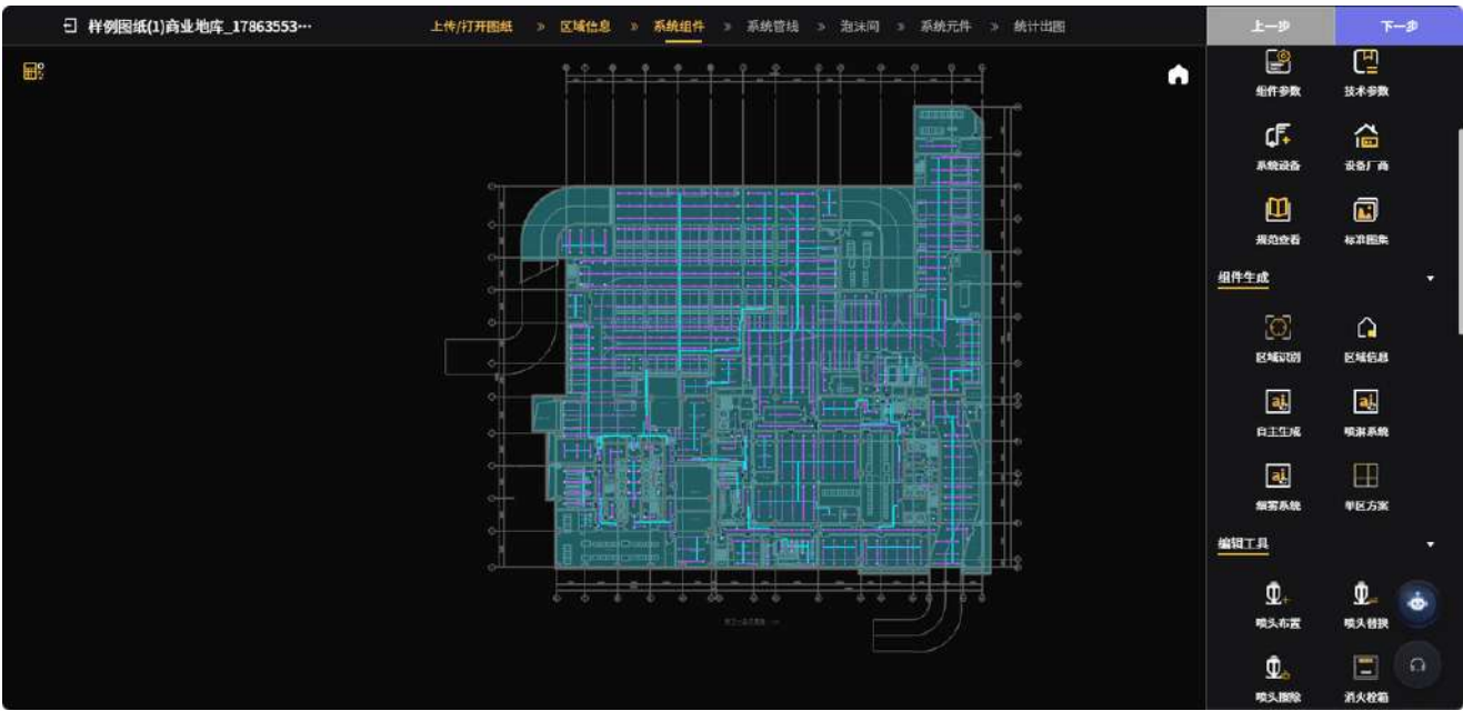
图3：系统自动生成喷淋系统图纸
